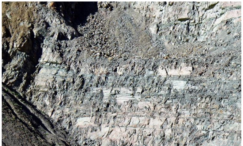
Photographie 6 : Alternance de leptynites claires et d'amphibolites sombres sur le front de taille des carrières du Chambon (source : association Géolozère)
